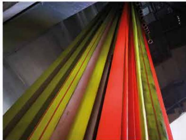
Trocknung gereinigter Schläuche im Schlauchturm
